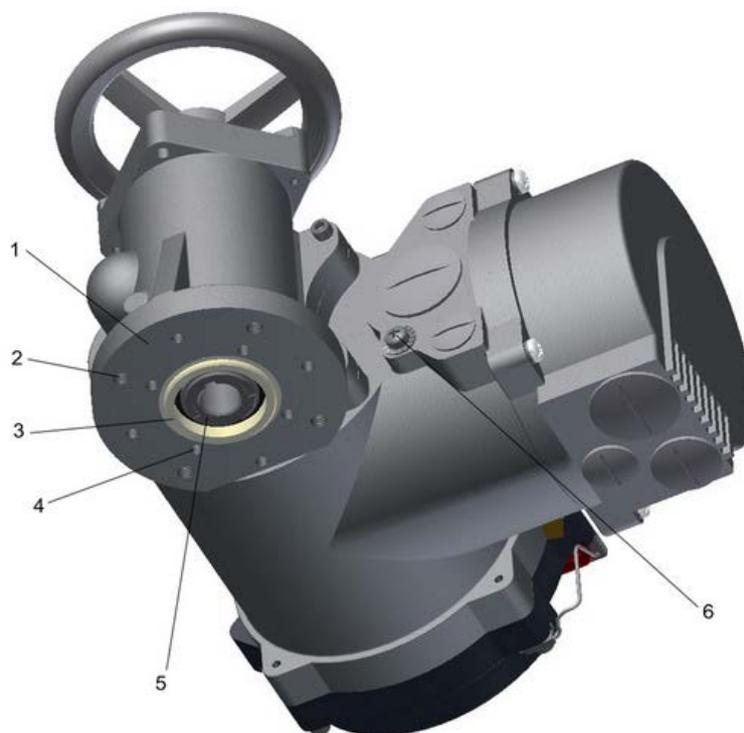
**Bild 22:** 1...Montageflansch, 2...Bohrbild G0/F10, 3...Zentrierrand, 4...Bohrbild F07, 5...Wellenverbindung, 6...Erdungsanschluss
