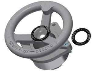
Die Kraft am Handrad wurde für die Einhandbetätigung ermittelt. Bei einer Zweihandbetätigung halbiert sich der Wert je Hand. Die maximale Kraft darf im Handbetrieb um 20% überschritten werden. Die Drehrichtung und das maximale Handraddrehmoment sind am Handradschild verzeichnet, siehe Abbildung oben.
