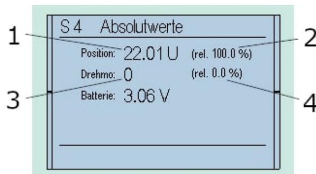
**Bild 81:** 1... Absolutwert der Positionseinheit, 2... Relativwert der Positionseinheit, 3 und 4... Absolut- und Relativwert der Drehmomenteinheit (wird im Werk kalibriert)
